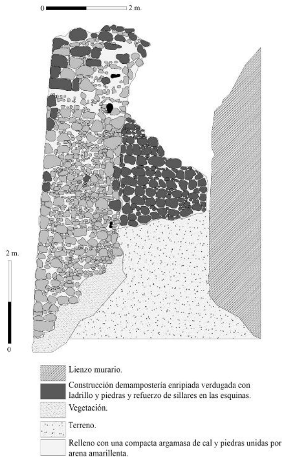
Figura 11. La Puerta de la Ciudad en su cara exterior sureste la técnica constructiva mampostería enripiada verdugada con ladrillo y piedras y refuerzo de sillares en las esquinas.
