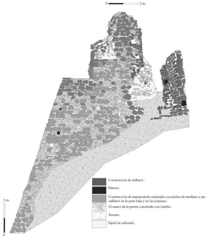
Figura 10. La puerta de la fortaleza en su cara exterior sureste la técnica constructiva es tapial de calicanto y mampostería enripiada. Las piedras son de diferente tamaño, se disponen verdugadas con ladrillo y piedras, y existe refuerzo de sillares.
